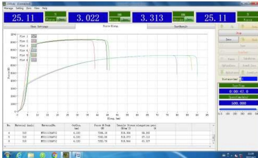
Gambar 25. Hasil Pengujian *Wire* Setelah *Annealing*
