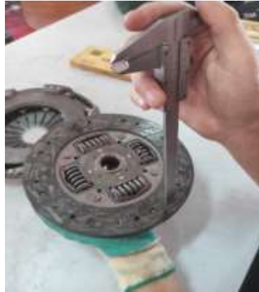
Gambar 5. Mengukur kedalaman paku keeling
