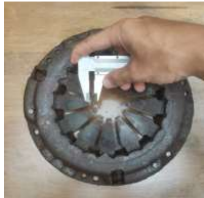
Gambar 8. Mengukur Lebar Keausan Pegas Diafragma
