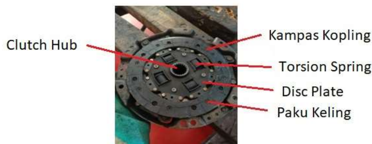
Gambar 4. Bagian Plat Kopling
