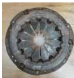
Gambar 6. Kerusakan Pada Matahari Kopling
