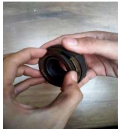
Gambar 10. Memeriksa kerusakan pada deklaher
