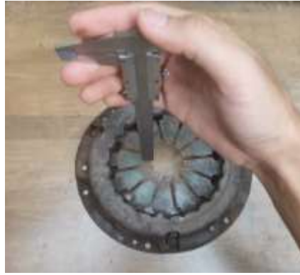
Gambar 7. Mengukur Kedalaman Pegas Diafragma
