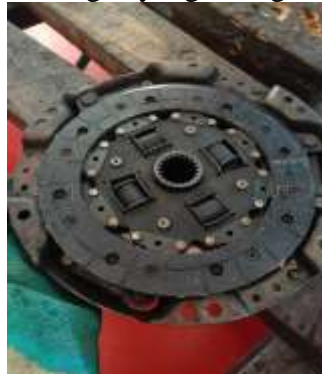
Gambar 3. Kerusakan pada kampas kopling
