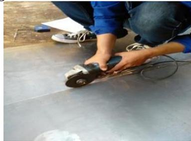
Gambar 8. Pemotongan Alas Karung
