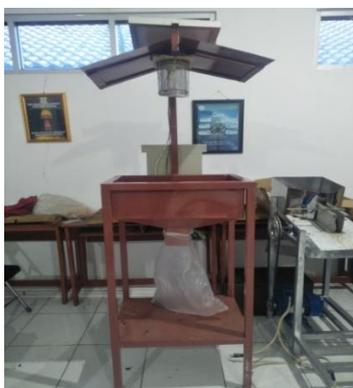
Gambar 1. Alat Perangkap Hama Wereng
