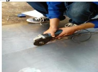
Gambar 11. Memotong Bak Penampung
