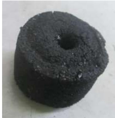
Gambar 6. Sampel Briket Arang Tempurung Kelapa
