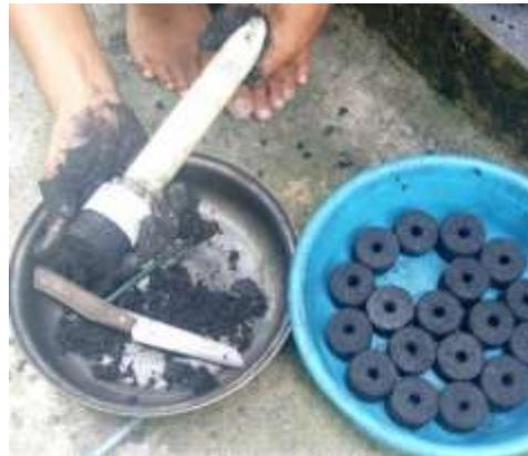
Gambar 2. Proses pencetakan briket dengan mekanis manual
