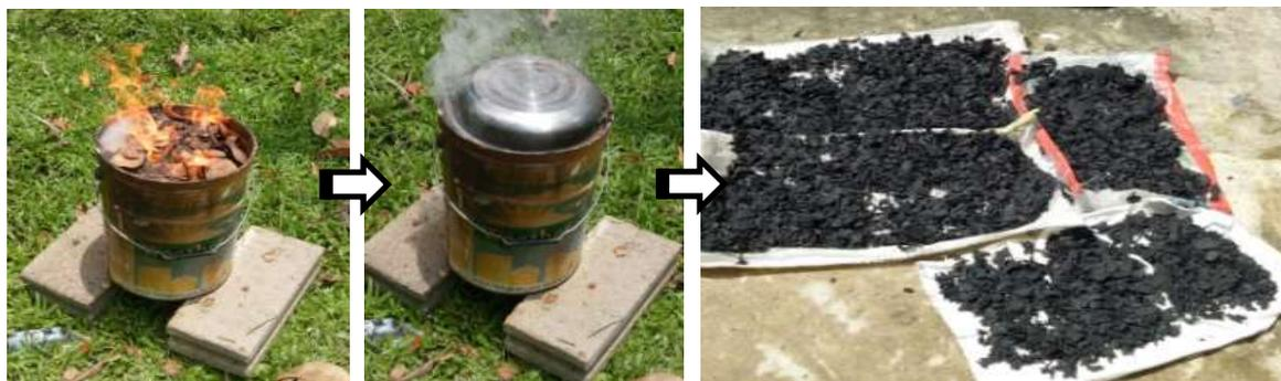
Gambar 1. Proses Pembuatan Arang dari Tempurung Kelapa
