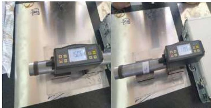
Gambar 3. Pengukuran dan penunjukan angka kekasaran permukaan
