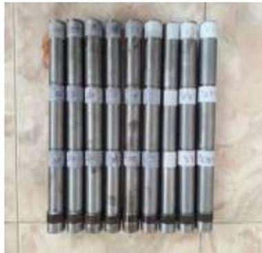
Gambar 2. Benda uji (*specimen*) uji kekasaran permukaan
